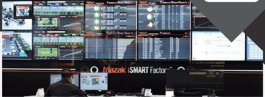
スマートファクトリー化を推進する、工作機械メーカーのヤマザキマザック。主力工場（美濃加茂製作所）の再編により、工場間の物流管理システムが必要になった。そこで、MotionBoardによってすべての部材（原材料・仕掛品）の位置・数量・滞留時間を可視化する独自の物流管理BI、「ID TRACKING PLUS」を開発。人が部材を探すための労力が減り生産性が向上したほか、在庫の適正化や資産管理の徹底にもつながった。
